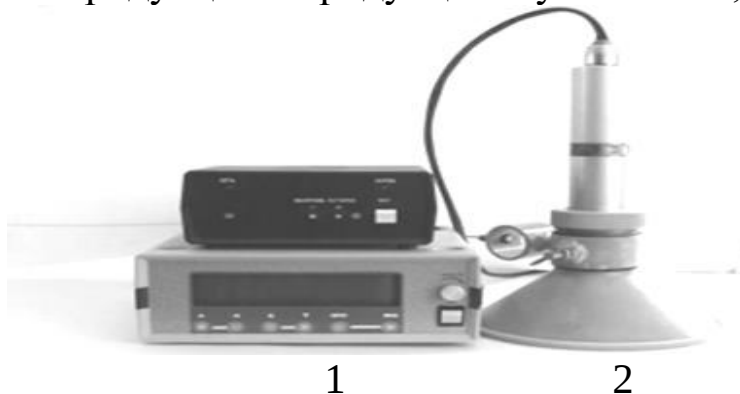
Рис. 7. Гамма-спектрометр СУГ-1М: 1 – зарядний пристрій і пульт керування; 2 – коліматор з блоком детектування.
