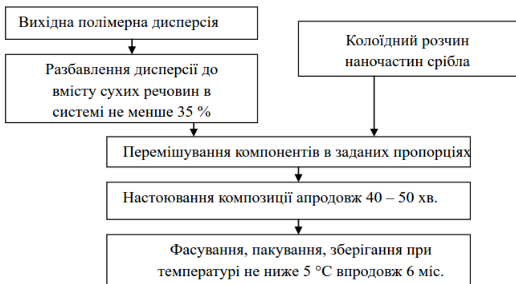
Рис. 10. Технологічна схема отримання модифікованої латексної композиції
