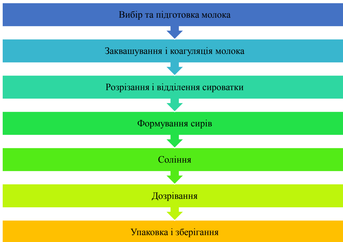
Рис.1.7. Основні етапи технології французьких м'яких сирів
