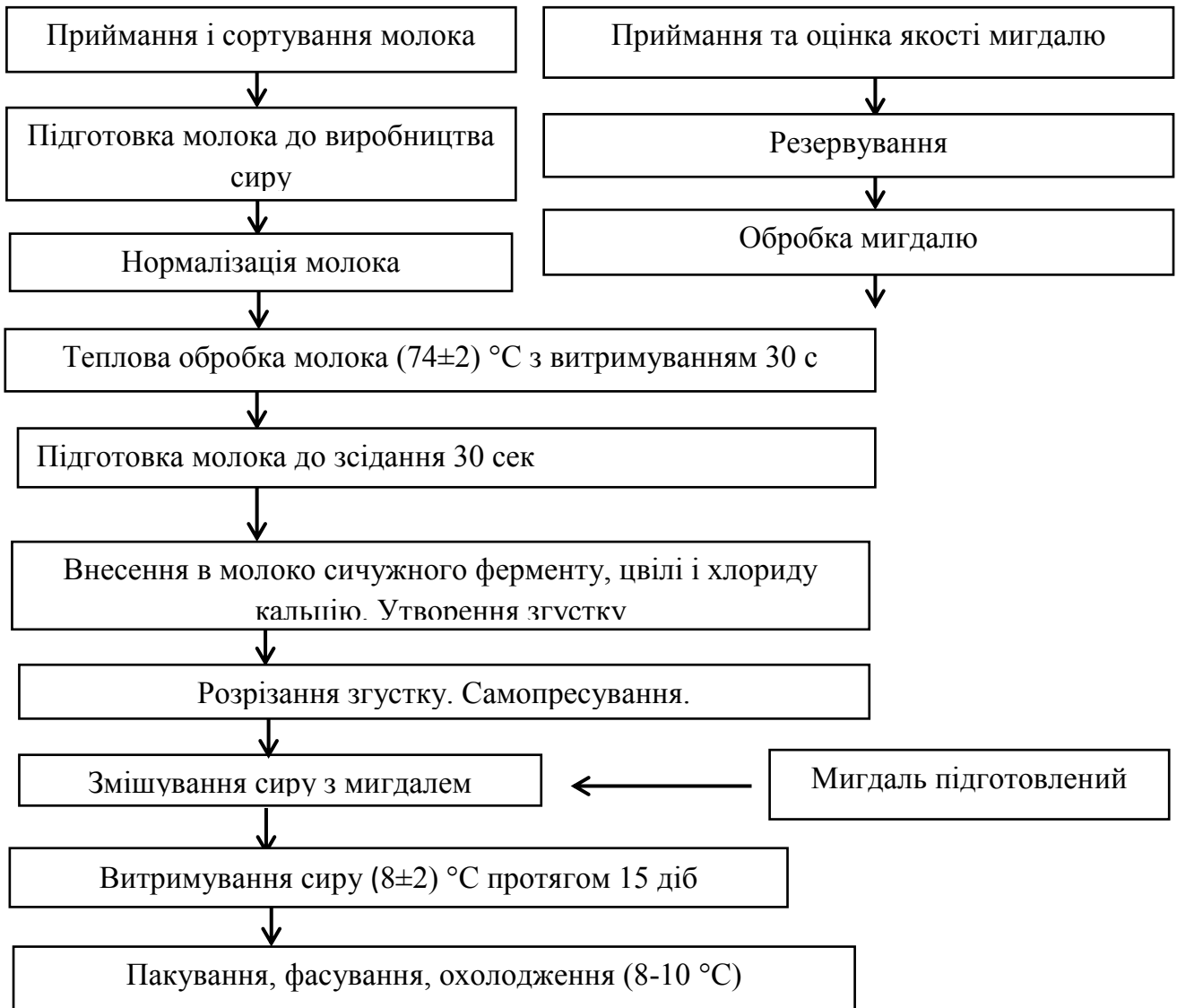
Рисунок 3.3 – Принципова схема технологічного процесу виготовлення сиру м'якого «Neufchâtel» з мигдалем
