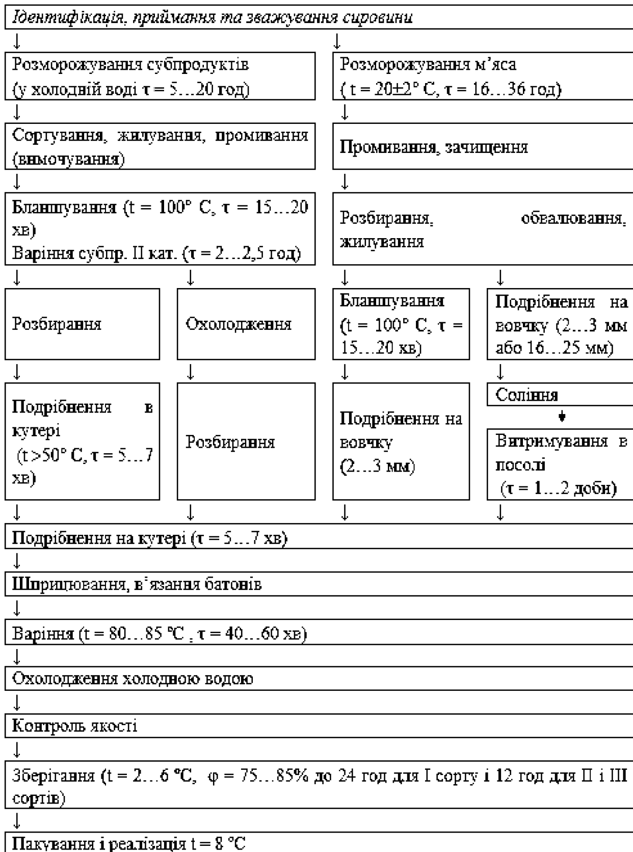
Рис. 4. Технологічна схема виробництва ліверних ковбас
