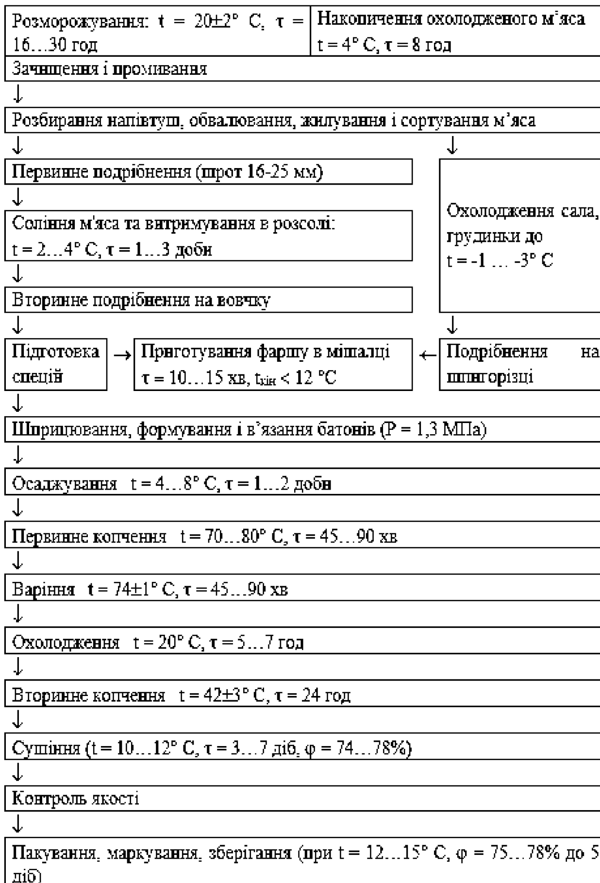
Рис. 3. Технологічна схема виробництва варено-копчених ковбас
