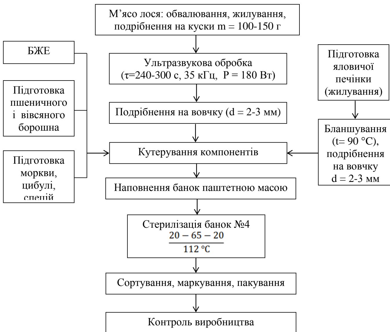
Рисунок 3.12. Технологічна схема виробництва паштету з м'яса лося
