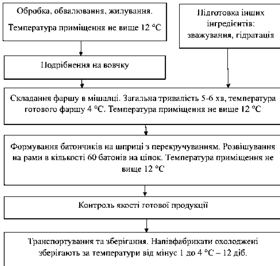
Рис. 1.2 – Технологічна схеми виробництва м'ясних посічених напівфабрикатів - ковбасок
