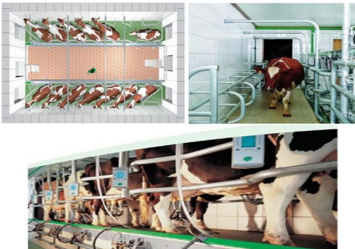
Мал.20. Технологічна схема доїльної установки "Ялінка" УДЕ-8.
