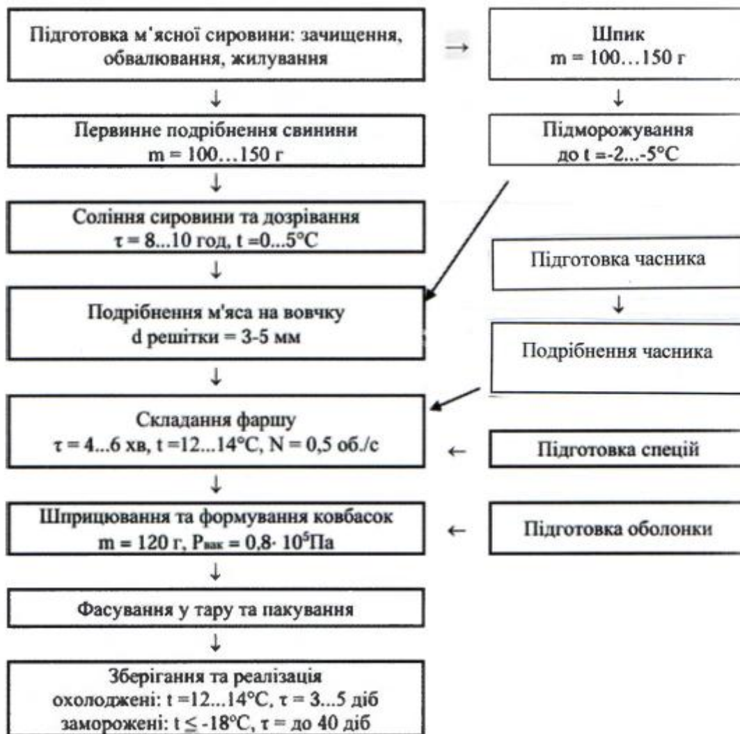
Рис. 3.1. Технологічна схема виробництва контрольного зразка грильових ковбасок
