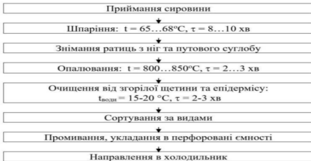
Рис. 5. Технологічна схема обробки шерстних субпродуктів
