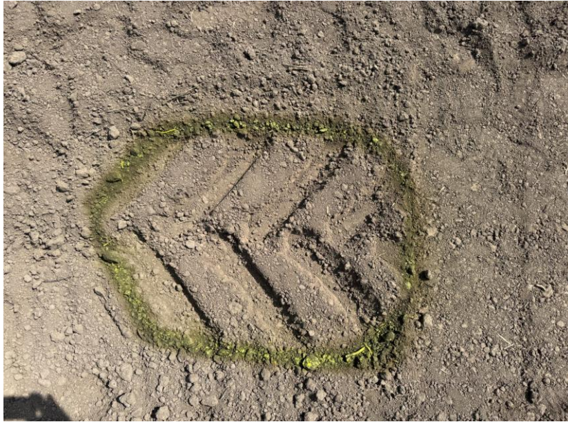
Рисунок 3.11 - Визначення плями контакту шини передньої осі трактора Fendt 1038 Vario
