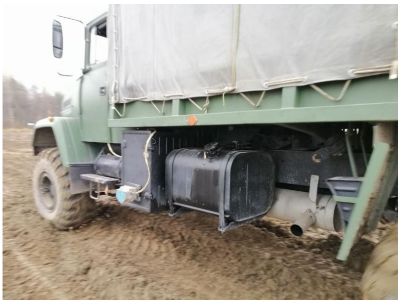
Рисунок 3.16 – Випробування КрАЗ з шинами 530/70-21 на зволоженому суглинку з твердістю CI = 610 кПа
