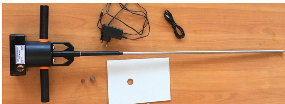
Рисунок 3.2 – Пьезоелектричний пенетрометр «ЛАН-М PRO» [237]
