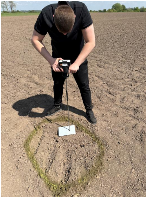
Рисунок 3. 8 -Фіксація плями контакту заднього колеса трактора на ґрунті і вимірювання твердості ґрунту
