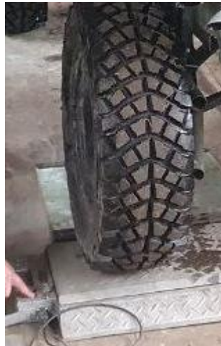
Рис. 3.3 – Автомобільні ваги INTERCOMP PT300DW заміру навантаження на колесо
