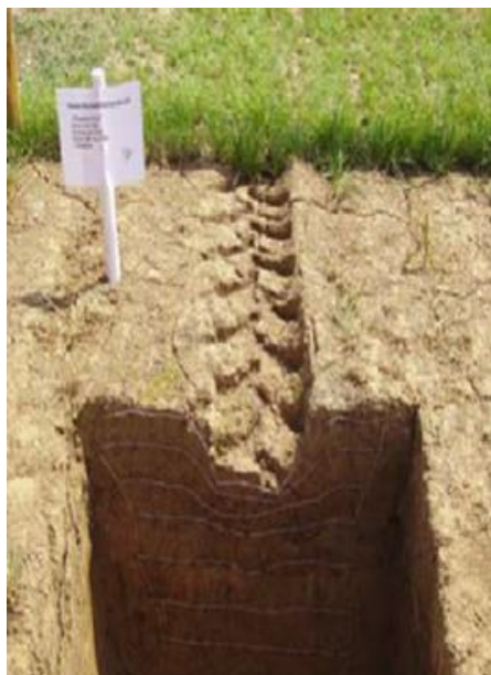
Рис.2.14 - Зміщення ліній деформації ґрунту навколо колії від колеса [169]
