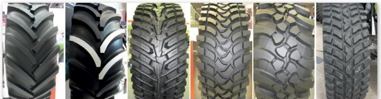
Abbildung 17: Reifenprofile für Ackerschlepper (von links nach rechts): 1. Mitas HC 2000, 2. Vredestein Traxion, 3. Michelin RoadBib, 4. Mitas HCM, 5. Trelleborg TH 500, 6. Nokian TRI 2 (Quelle: Uppenkamp)
