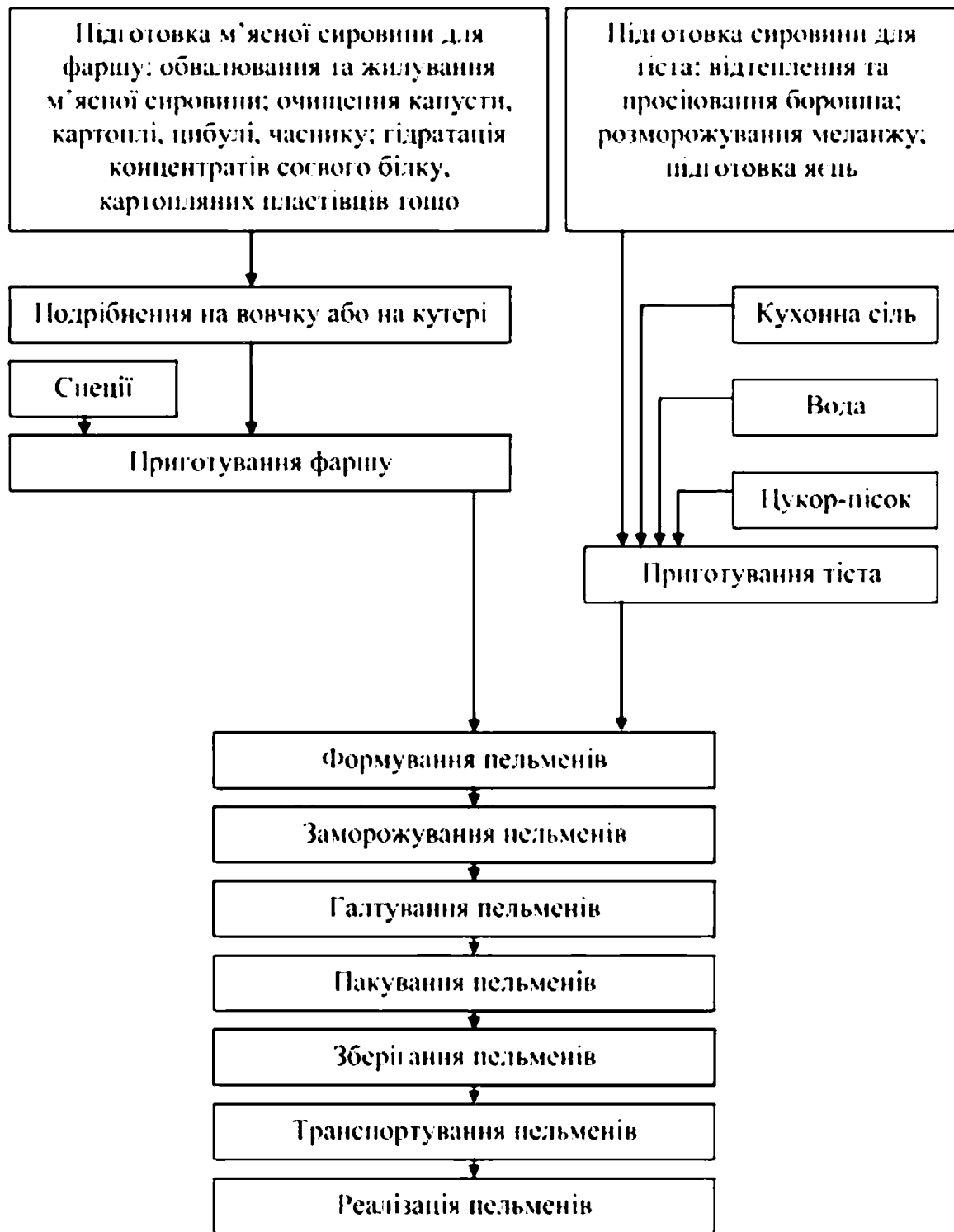
Рис. 1.1. Технологічна схема виробництва пельменів
