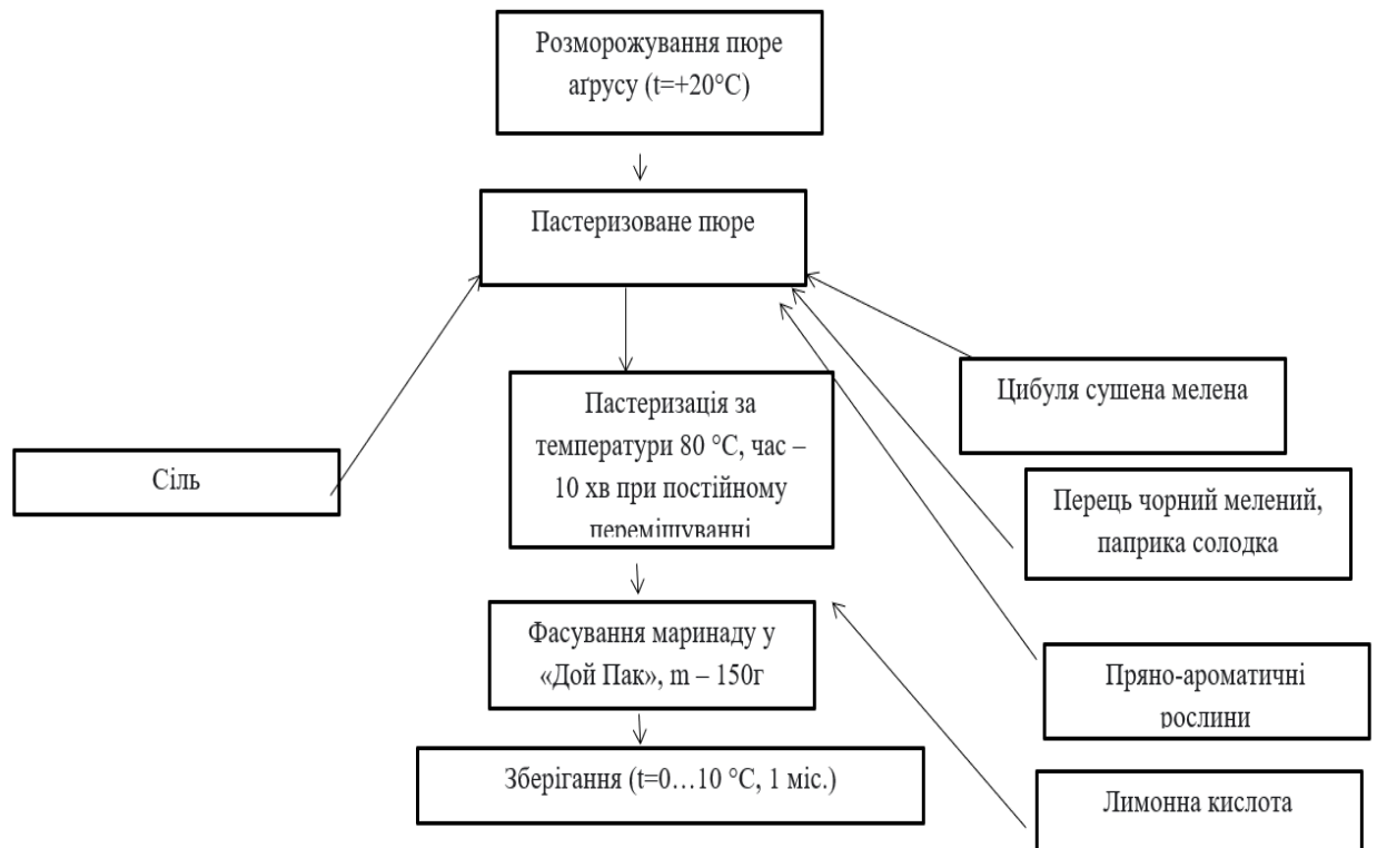
Рис. 3.2. Технологічна схема приготування маринаду з пюре агрусу
